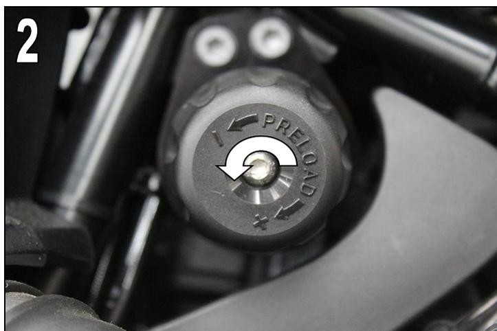
Utilice un destornillador Torx adecuado para aflojar el tornillo de fijación del volante original para el ajuste del amortiguador y retire el volante.
