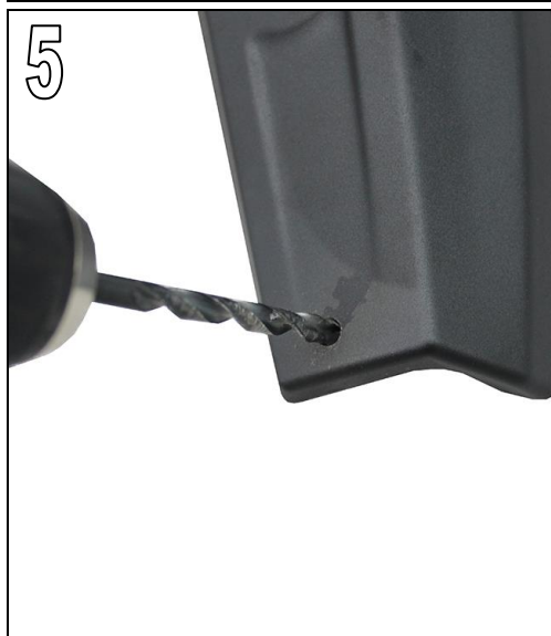
Fig. 5 Taladre la marca transferida con una broca de Ø 6,5 mm.
