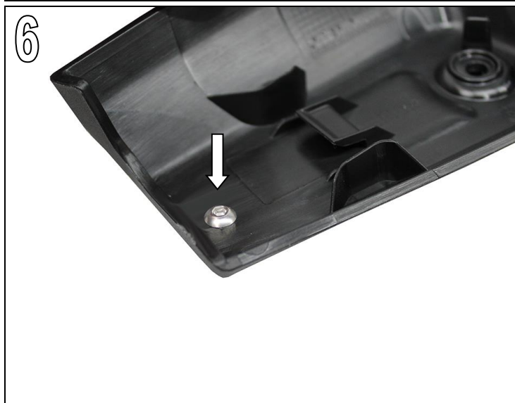
Fig. 6 Atornillela tapa AC Schnitzer a la barra de fijación inferior con el tornillo de cabeza plana M4x5mm suministrado deserie.
