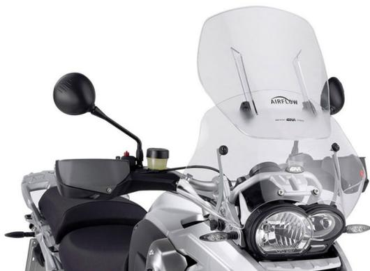
AIRFLOW está en el máximo nivel, con la versatilidad de un parabrisas. Para eso está la habilidad de adaptarlo, en pocos segundos, a la altura del piloto o de acuerdo a las condiciones climáticas actuales, gracias a su spoiler, con altura ajustable de manera fácil y rápida.
