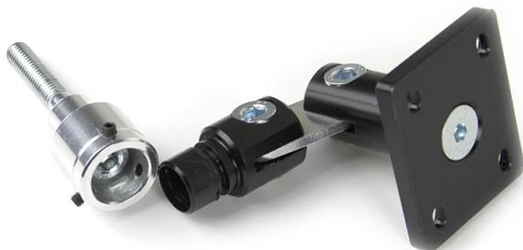
Hay que apretar el tornillo base (rosca M8) a la montura para manillar. Después se atornilla la placa móvil para GPS a la montura. Las unidades GPS Garmin y TomTom para motocicleta pueden instalarse sin ningún problema. Pero también es posible ajustar la placa de plástico de manera muy sencilla para otros dispositivos.
