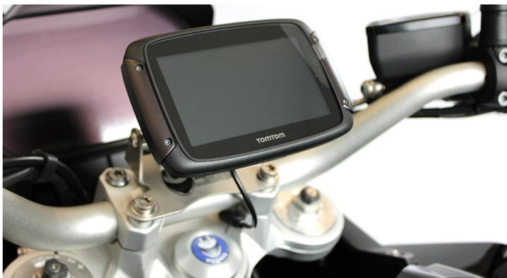
Soporte para GPS en la abrazadera del manillar: para fijar su dispositivo de navegación o teléfono inteligente en la abrazadera del manillar.
